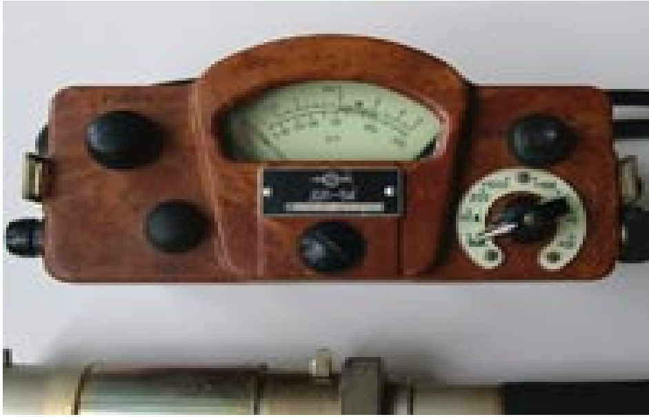
Şəkil: DP-5A radio-rentgenmetrinin ölçmə pultu; 1- rejimi tənzimləyən poten-siometr; 2-cihazın göztəricisini pozmaq üçün düymə; 3-elektrik-ölçü cihaz; 4-şkalanın işıq tumbleni; 5-yarımdiapazonlar çevirgəcləri; 6-əqrəbi sıfır üzərinə gətirmək üçün (qoruyucu) vint; 7-telefon yuvası.
