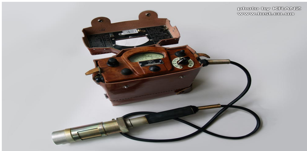
Şəkil: DP-5A rentgenmetrinin ümumi görünüşü.
