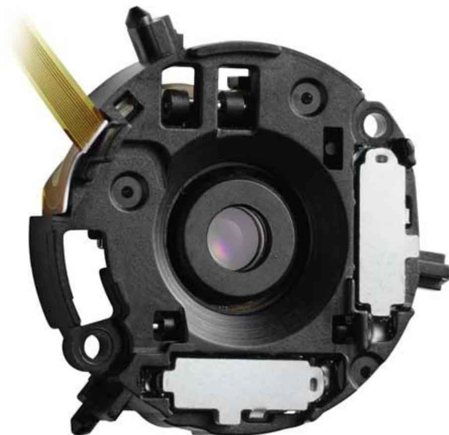
*Блок оптического стабилизатора MEGA O.I.S.*
