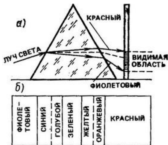
Рис. 4. Призматический (дисперсионный) спектр а — разложение луча света призмой; б- диапазоны цветов видимей части
