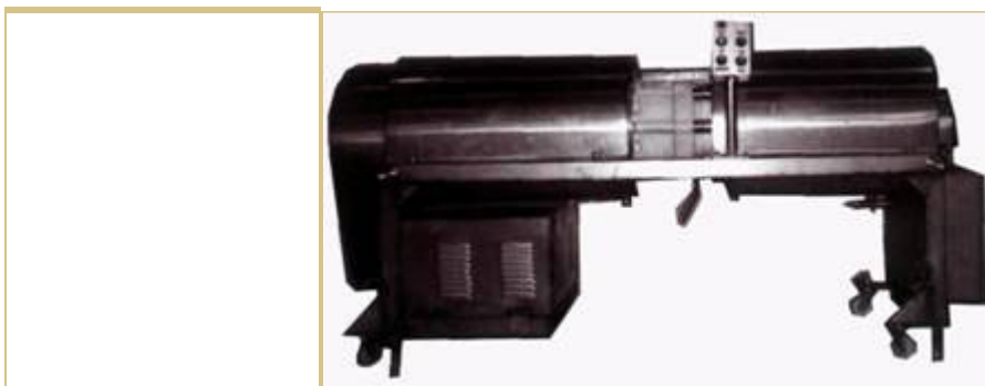
Рисунок 6- Машина Я6-ФОО для обвалки окорочков
