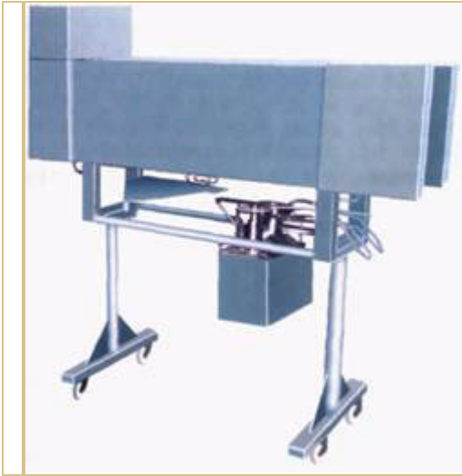
Рисунок 5- Машина Э-1106 для разделки тушек птицы
