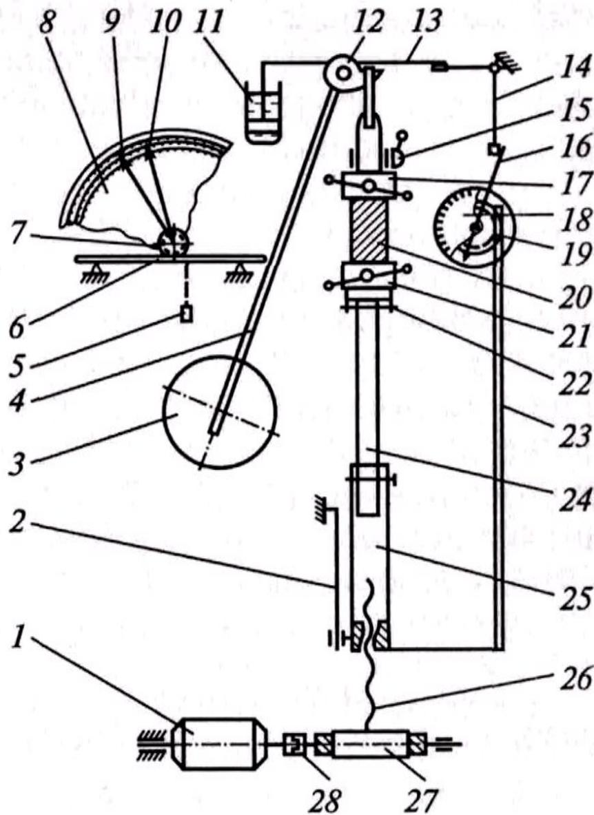
Рис. 4. Схема разрывной машины РТ-250М-2:
