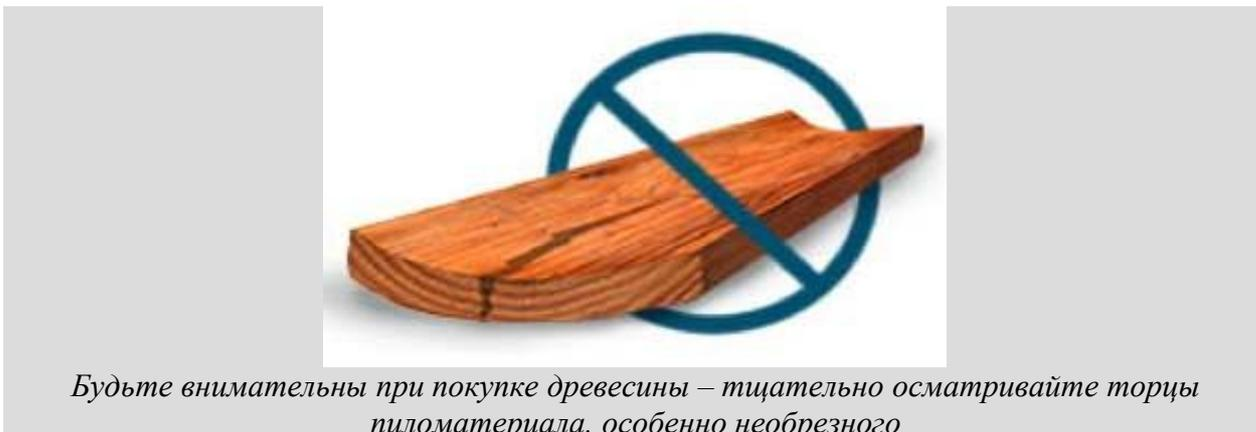
Торцевые трещины так же являются распространенным дефектом пиломатериалов и вызваны быстрым высыханием концов досок. Покрытие торцевых частей водозащитной краской может предотвратить растрескивание.
