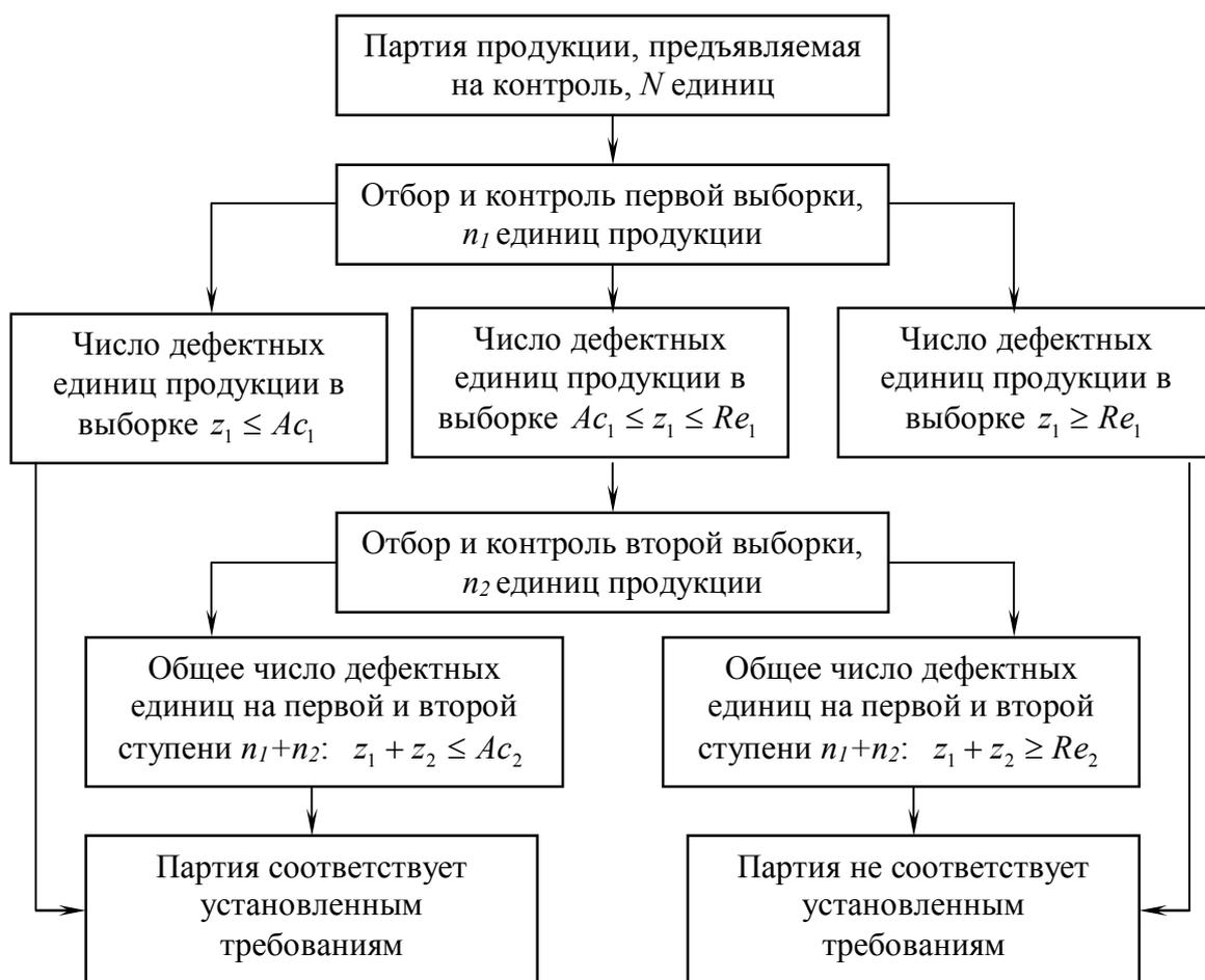
Рис. 4. Схема двухступенчатого плана выборочного контроля
