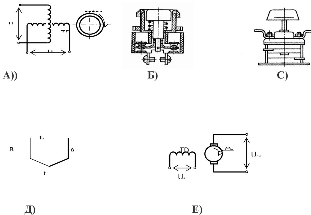
**58. Какие электрические термометры используются для измерения температуры?**
