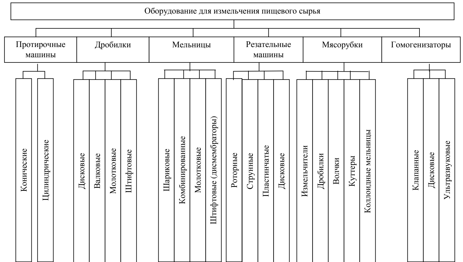
Рис. 9.7. Классификация оборудования для измельчения пищевого сырья
