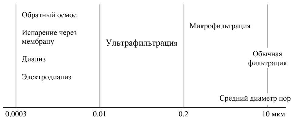
Рис. 8.1. Классификация мембранных процессов
