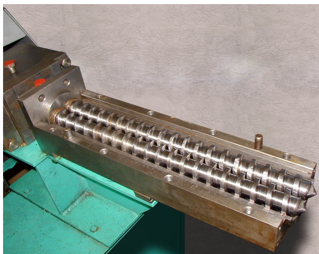
Рис. 12.24. Рабочая камера двухшнекового экструдера
