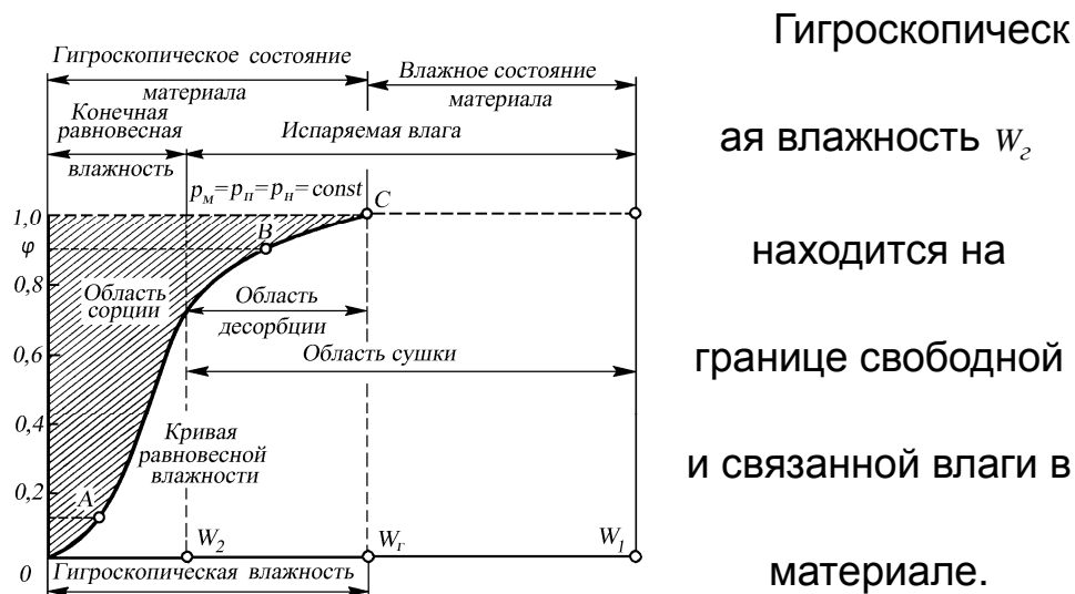
Рис. 19.3. Схема классификации влаги в материале в увязке с процессом ее удаления при сушке
