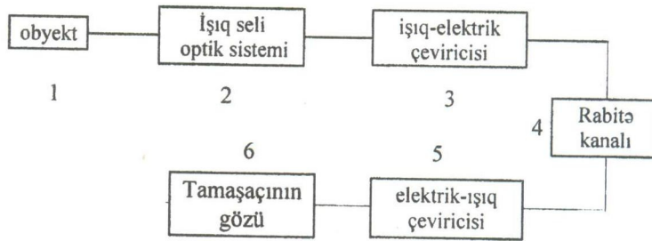
Şək.1.1. Televiziya sisteminin struktur sxemi
