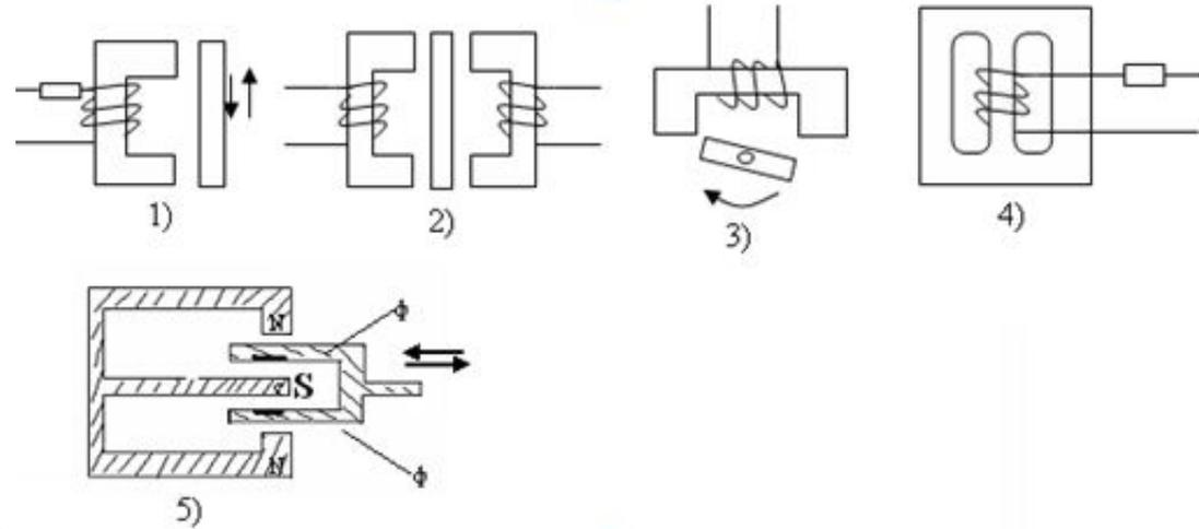
460) Sual: Показать схему магнитоэлектрического передатчика.
