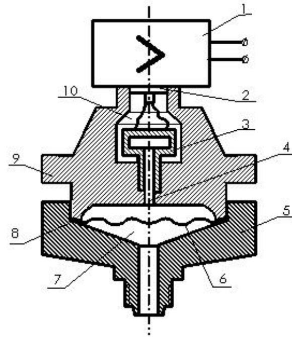
361) Sual: Измерительный блок в приведенной схеме манометра.....
