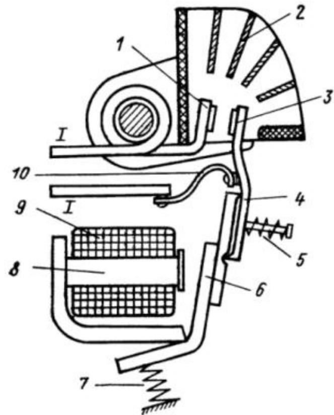
681) Sual: Укажите якорь, на данной схеме контактора постоянного электрического тока?
