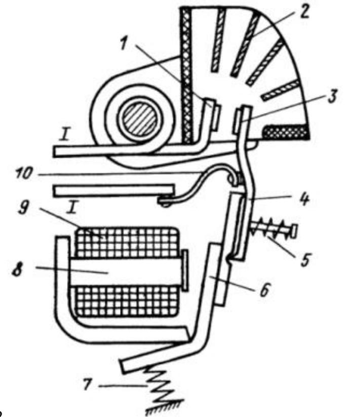
551) Sual: Укажите пружину, на данной схеме контактора постоянного электрического тока?
