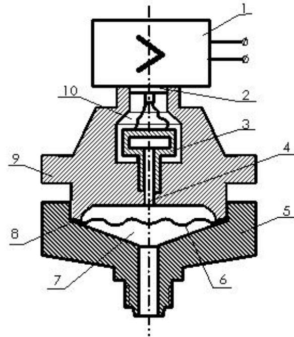
364) Sual:тензопередатчик типа мембран в ниприведенной схеме манометра.....
