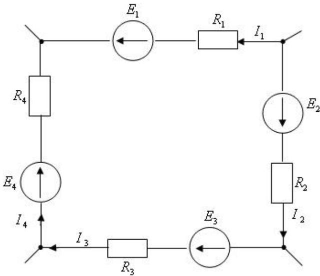
$$\textcircled{1} \quad E_1 + E_4 + E_3 - E_2 = R_1 I_1 + R_2 I_2 + R_3 I_3 - R_4 I_4$$
