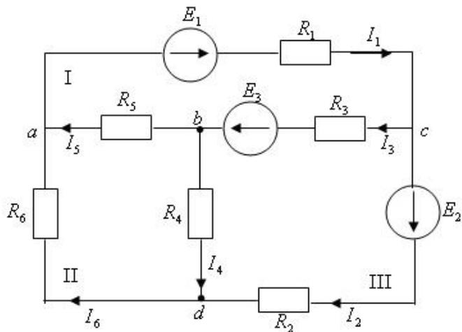
$I_3 - I_4 + I_5 = 0; I_1 R_1 + I_3 R_3 + I_5 R_5 = E_3 + E_1$
