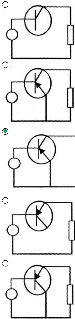
687 Giriş və çıxış siqnalları üçün emitter siqnalı eyni olan halda, tranzistorun qoşulması necə adlandırılır?
