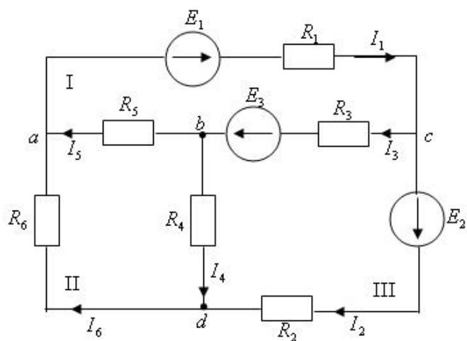
$$I_3 - I_4 - I_5 = 0 \quad I_2 R_2 - I_4 R_4 - I_3 R_3 = E_2 - E_3$$
