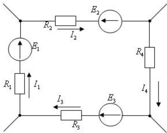
$$\text{Q}_1 - E_2 - E_3 = I_1 R_1 - I_2 R_2 + I_3 R_3 + I_4 R_4$$
