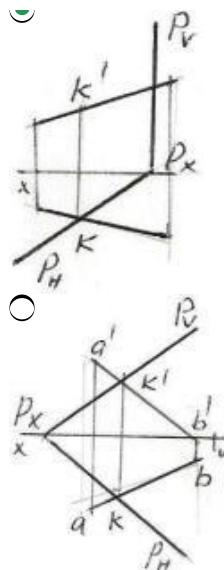
602 Hansı epyurda P və Q ilə müstəviləri arasındaki məsafənin əsl ölçüsü 1 düzgün göstərilmişdir?
