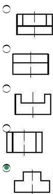
375 По заданным двум проекциям правильно определить третью проекцию.
