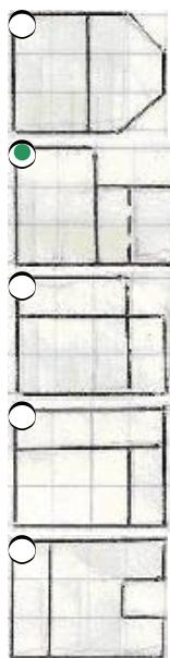
477 На каком чертеже согласно двум проекциям правильно построена профильная проекция модели?
