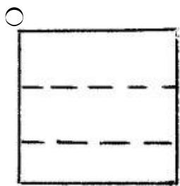
362 По заданным двум проекциям правильно определить третью проекцию.
