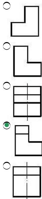
364 По заданным двум проекциям правильно определить третью проекцию.
