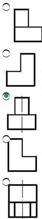
369 По заданным двум проекциям правильно определить третью проекцию.
