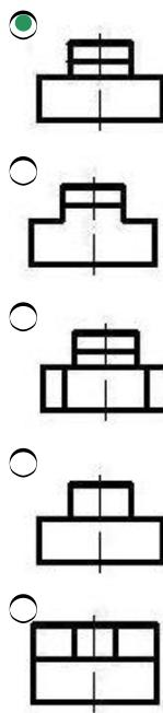
381 Согласно двум проекциям модели, определите, на каком чертеже правильно построена третья?
