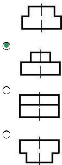
374 По заданным двум проекциям правильно определить третью проекцию.
