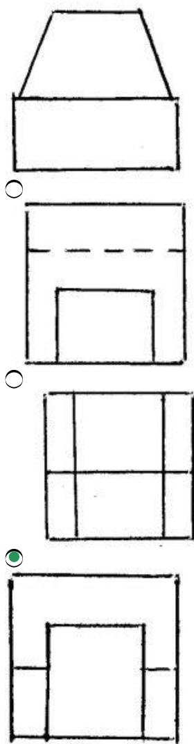
398 Согласно двум проекциям модели, определите, на каком чертеже правильно построена третья?
