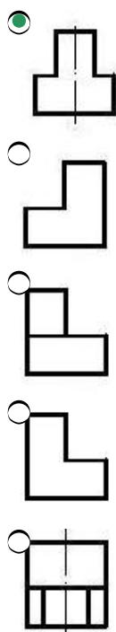
368 По заданным двум проекциям правильно определить третью проекцию.
