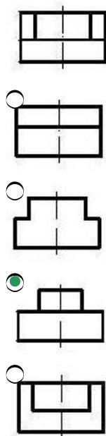
376 По заданным двум проекциям правильно определить третью проекцию.
