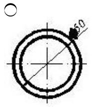
79 какой знак должен быть проставлен перед размерным числом для обозначения указанной поверхности?
