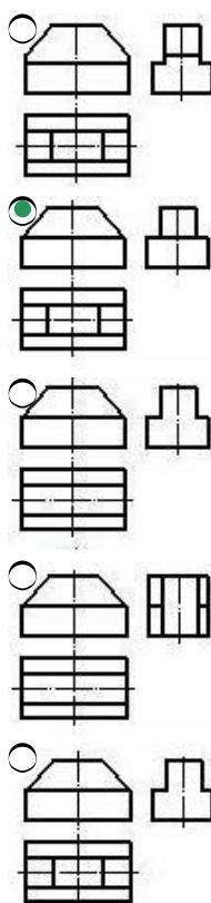
466 По наглядному изображению модели определить ее изображение на комплексном чертеже.
