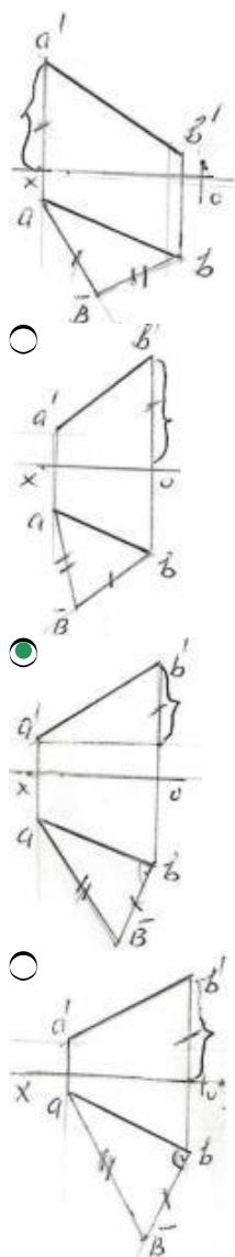
222 На каком чертеже изображен угол наклона заданной прямой к горизонтальной плоскости проекций?
