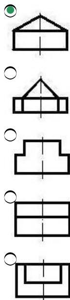
379 По заданным двум проекциям правильно определить третью проекцию.
