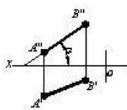
223 На каком чертеже изображен угол наклона заданной прямой к фронтальной плоскости проекций?
