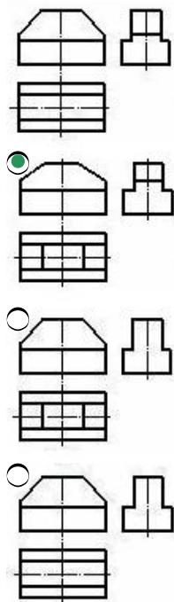
467 По наглядному изображению модели определить ее изображение на комплексном чертеже.
