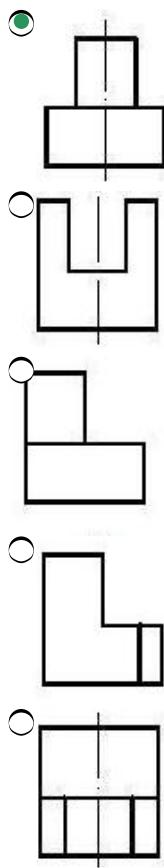
370 По заданным двум проекциям правильно определить третью проекцию.
