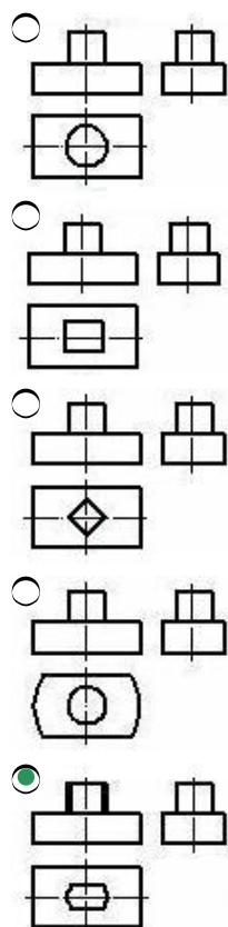
469 По наглядному изображению модели определить ее изображение на комплексном чертеже.
