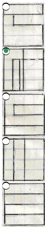
475 На каком чертеже согласно двум проекциям правильно построена горизонтальная проекция модели?
