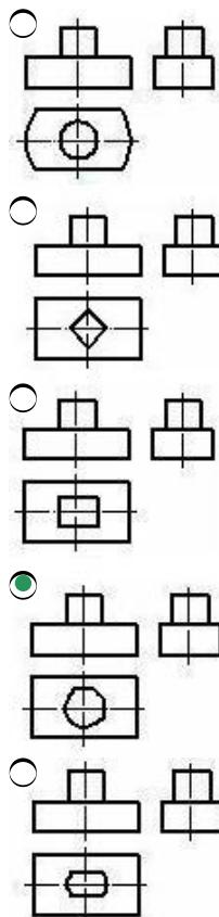
18 На каком чертеже согласно двум проекциям правильно построена профильная проекция модели?
