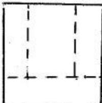
661 По заданным двум проекциям правильно определить третью проекцию.
