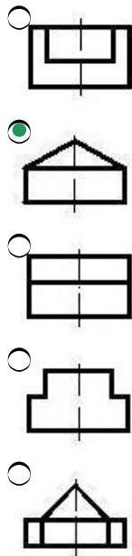
664 По заданным двум проекциям правильно определить третью проекцию.
