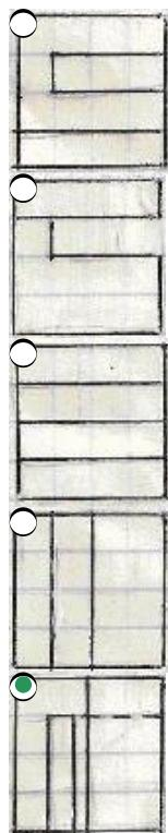
45 На каком чертеже согласно двум проекциям правильно построена горизонтальная проекция модели?
