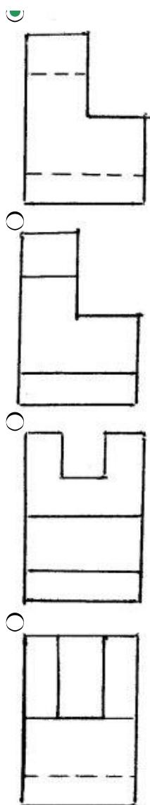
643 Согласно двум проекциям модели, определите, на каком чертеже правильно построена третья?
