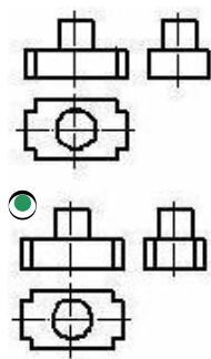
12 По наглядному изображению модели определить ее изображение на комплексном чертеже.
