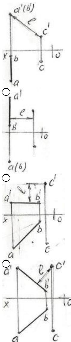
463 В каких случаях фронтальная проекция прямого угла, образованного двумя пересекающимися прямыми, проецируется в натуральную величину?
