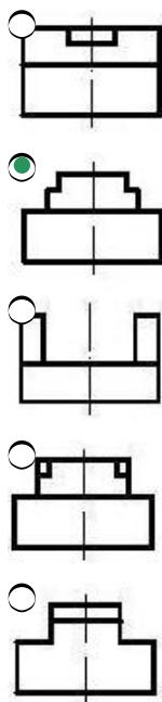
663 По заданным двум проекциям правильно определить третью проекцию.
