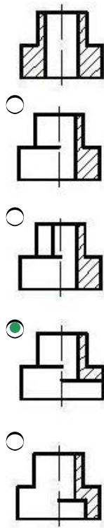
581 По заданным двум проекциям правильно определить третью проекцию.
