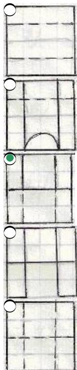
47 На каком чертеже согласно двум проекциям правильно построена профильная проекция модели?
