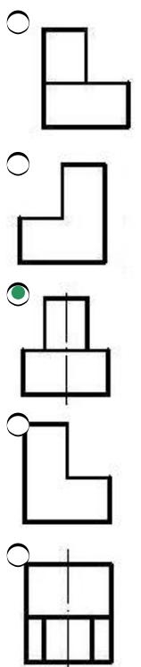
650 По заданным двум проекциям правильно определить третью проекцию.
