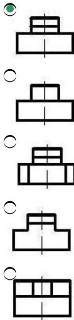
662 По заданным двум проекциям правильно определить третью проекцию.
