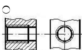
571 По заданным двум проекциям правильно определить третью проекцию.
