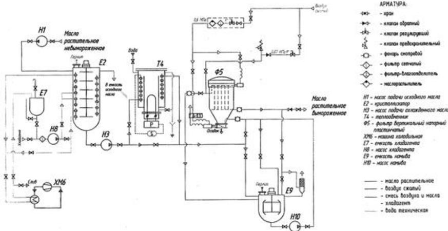
645 Какая из технологических схем является схемой линии подготовки сырого нерафинированного масла к процессу этерификации (рафинация)?
