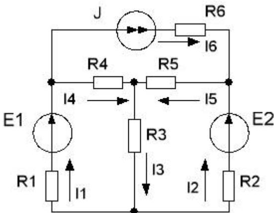
$Q_6 R_6 + I_5 R_5 - I_4 R_4 = JR_6$ .
