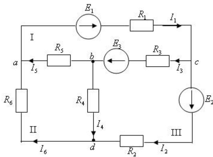
$$\begin{aligned} \text{Q1} - I_4 + I_5 &= 0 & I_1 R_1 + I_3 R_3 + I_5 R_5 &= E_3 + E_1 \\ \text{Q2} - I_4 - I_5 &= 0 & I_2 R_2 - I_4 R_4 - I_5 R_5 &= E_2 - E_3 \\ \text{Q3} + I_4 - I_5 &= 0 & I_2 R_2 - I_4 R_4 + I_3 R_3 &= E_2 - E_3 \\ \text{Q4} - I_4 - I_5 &= 0 & I_2 R_2 + I_4 R_4 + I_3 R_3 &= E_2 + E_3 \\ \text{Q5} + I_4 + I_5 &= 0 & I_3 R_3 + I_4 R_4 + I_2 R_2 &= E_2 + E_3 \end{aligned}$$
