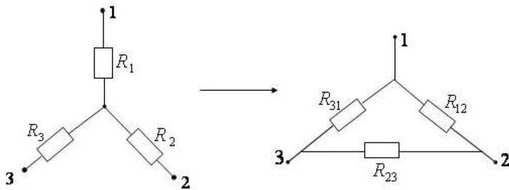
$$\text{O } R_{12} = \frac{R_1 + R_2 + R_3}{R_2 R_3} \quad R_{23} = \frac{R_1 + R_2 + R_3}{R_1 R_3} \quad R_{31} = \frac{R_1 + R_2 + R_3}{R_1 R_2}$$
