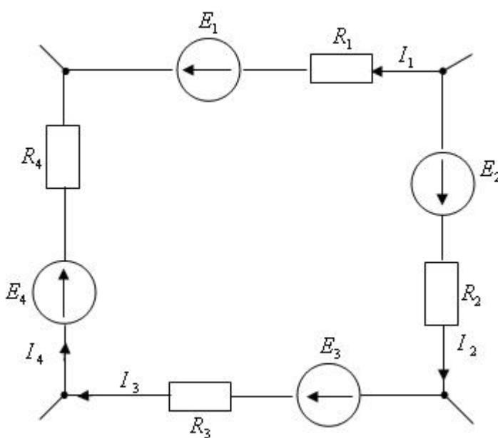
$E_2 + E_3 + E_4 - E_1 = -R_1I_1 + R_2I_2 + R_3I_3 + R_4I_4$
