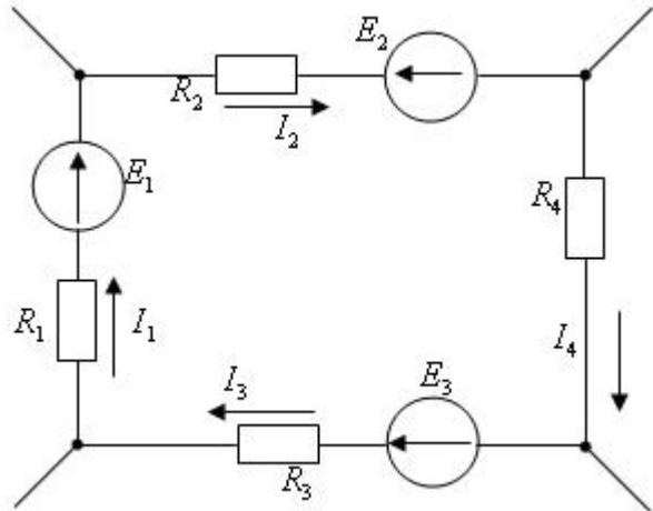
$$\begin{aligned} \text{Q1} - E_2 - E_3 &= I_1 R_1 - I_2 R_2 + I_3 R_3 + I_4 R_4 \\ \text{Q1} + E_2 - E_3 &= I_1 R_1 - I_2 R_2 - I_3 R_3 + I_4 R_4 \\ \text{Q1} - E_2 + E_3 &= I_1 R_1 + I_2 R_2 + I_3 R_3 + I_4 R_4 \\ \text{Q1} + E_2 + E_3 &= I(R_1 + R_2 + R_3 + R_4) \\ \text{Q1} + E_2 - E_3 &= I_1 R_1 + I_2 R_2 + I_3 R_3 - I_4 R_4 \end{aligned}$$
