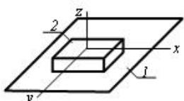
поступательное вдоль оси x, вращательное вокруг оси x
