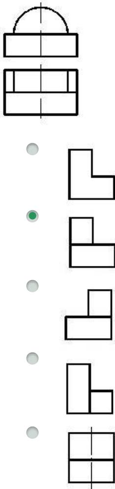
433 Согласно двум проекциям модели, определите, на каком чертеже правильно построена третья?
