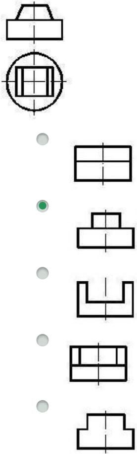
466 По заданным двум проекциям правильно определить третью проекцию.
