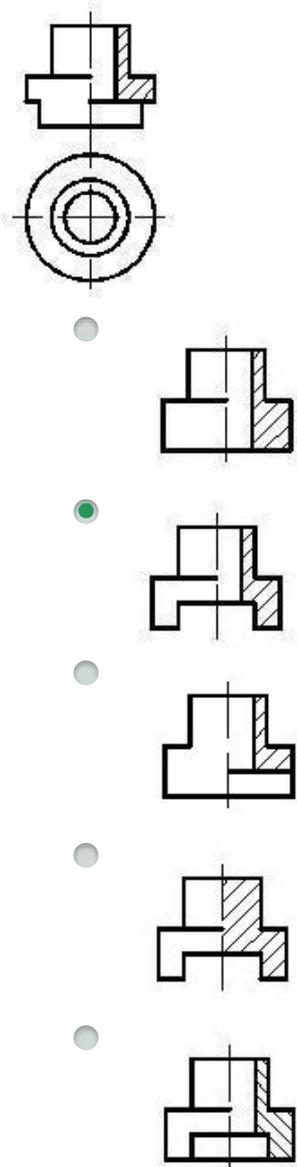
382 По заданным двум проекциям правильно определить третью проекцию.
