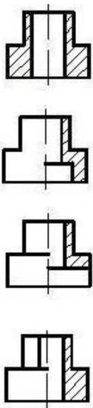
381 По заданным двум проекциям правильно определить третью проекцию.
