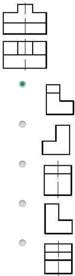
455 Согласно двум проекциям модели, определите, на каком чертеже правильно построена третья?
