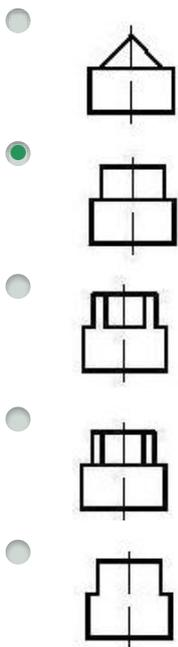
465 По заданным двум проекциям правильно определить третью проекцию.
