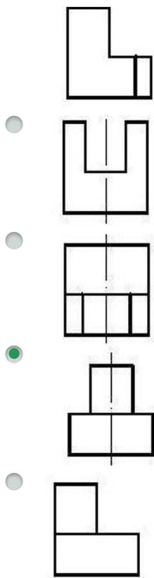
449 По заданным двум проекциям правильно определить третью проекцию.
