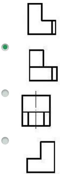
454 По заданным двум проекциям правильно определить третью проекцию.
