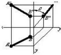
293 На каком чертеже изображен угол наклона заданной прямой к горизонтальной плоскости проекций?
