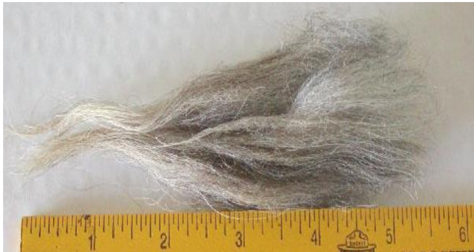
Şəkil 3.2. Yun lifinin qıvrımlığının ölçülməsi
