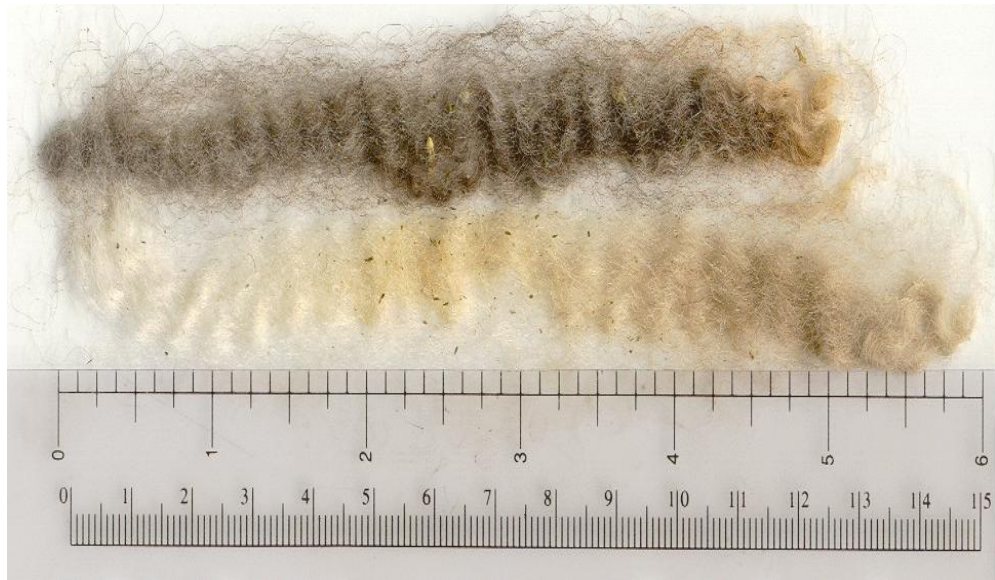
Şəkil 3.1. Yun lifinin uzunluğunun ölçülməsi
