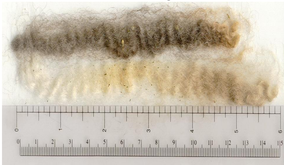
Şəkil 3.1. Yun lifinin uzunluğunun ölçülməsi
