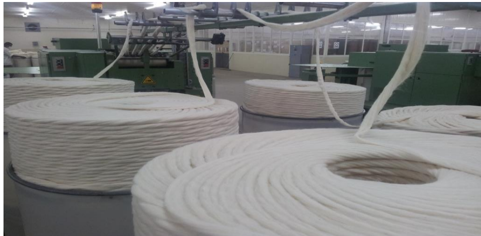
Şəkil 1.24.Hazırlanan vatkalарın nazikləşdirilməsi mərhələsi
