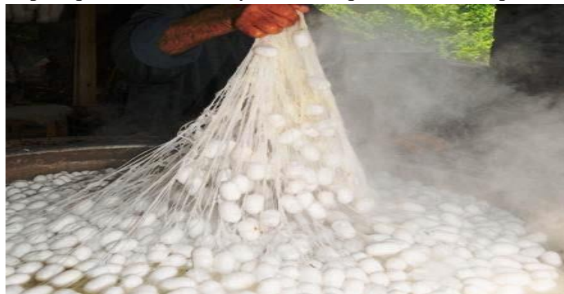
Şəkil 1.9. İpək qozalarının isti suya salınaraq lifin ucunun tapılması prosesi.
