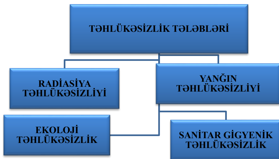
Şəkil 1.6. Polimer inşaat materiallarının keyfiyyətinə verilən təhlükəsizlik tələbləri
