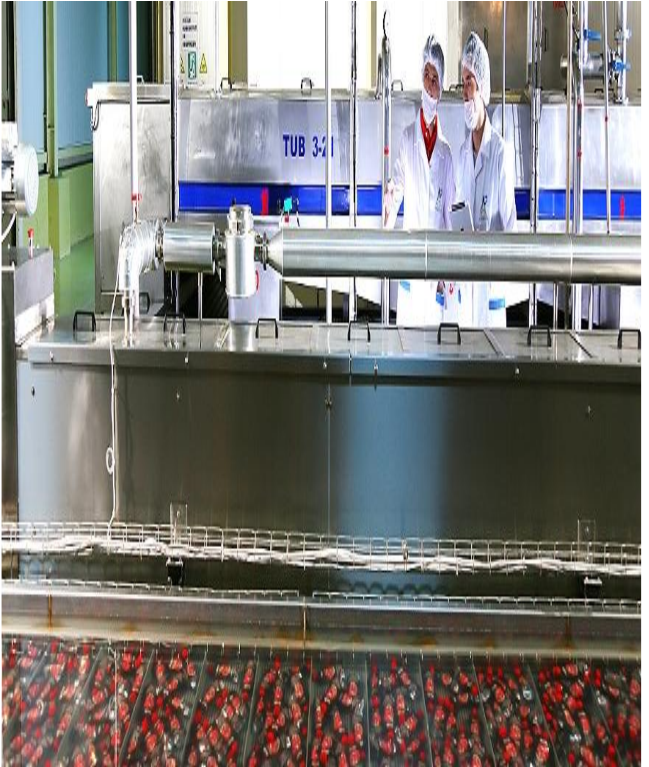
Şəkil 6. Ət konservlərinin əsas istehsal əməliyyatları aparılan sex.
