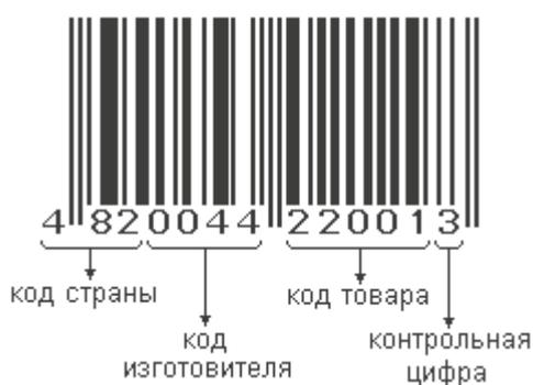
Рис. 2.1. Структура штрихового кода EAN-13
