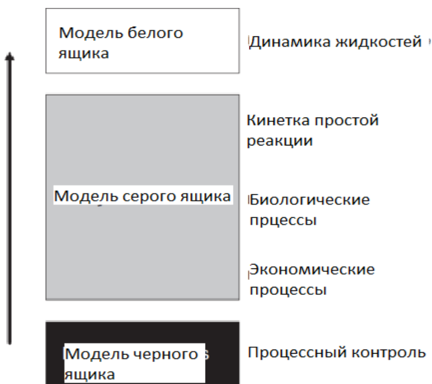
Рис. 3.2. Физическая интерпретация моделей серого ящика и примеры приложений
