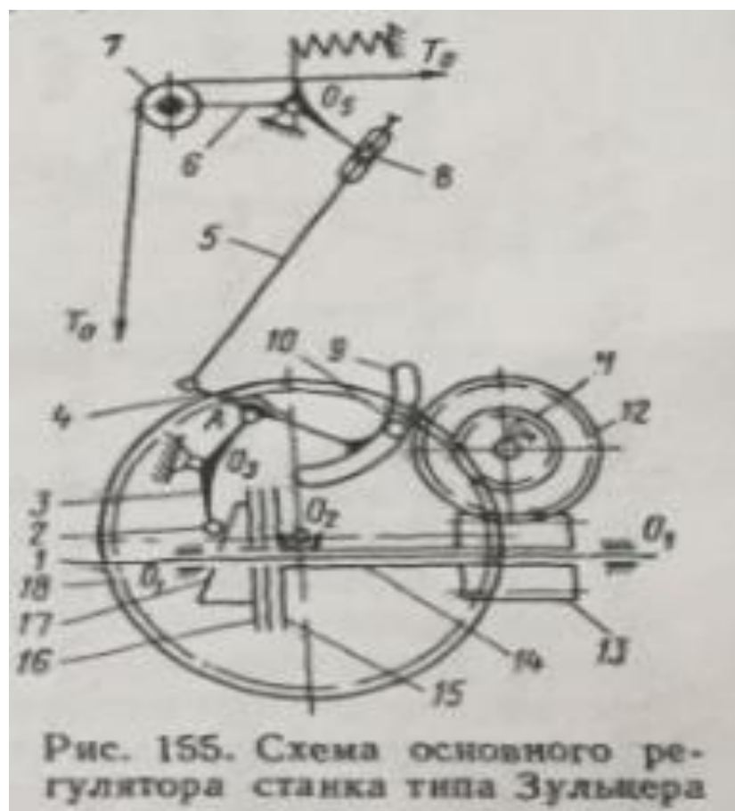
Qoldakı 4 yarıq vintə 9 doğru əyilmiş və yuxarı ucu aşağı çəkmədən A daha uzadır, hərəkət zamanı qol 4 sola doğru hərəkət edir, ucunun əks tərəfindəki rolik 2 olan iki qollu 3 qolu 4 saatın ərqəbin əks istiqamətində dönür.
