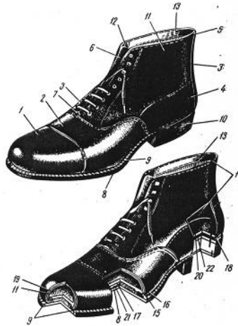
Şəkil.2.6. Çəkmənin detalları (qısa boğaz çəkmə)
