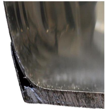
Şəkil 2.1. Polad qazanın en kəsiyi.
