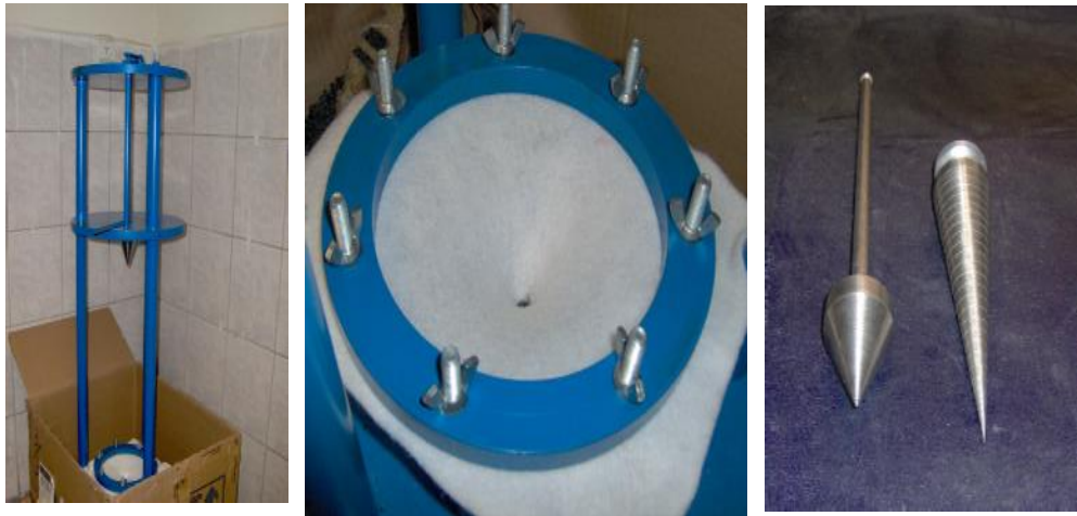
Şəkil 3.1.7. Pazşəkilli düşmə test sistemi, konusşəkilli təsiredici və ölçmə konusu
