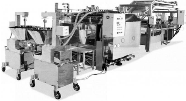
Şəkil 9.1. Krab çubuqlarının istehsalının axın xətti
