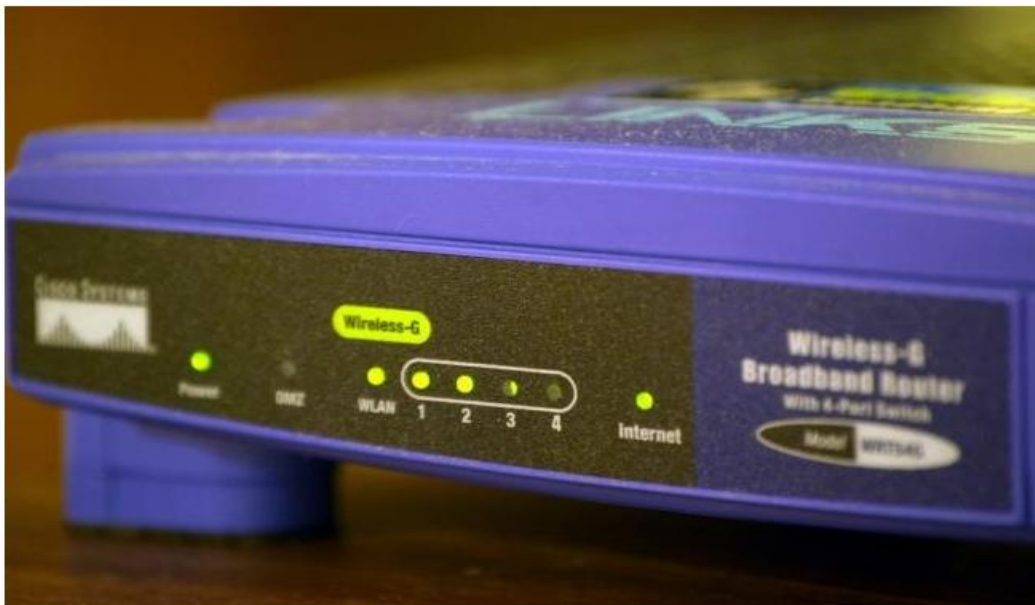
Şəkil 3.1. Adhoc şəbəkəsində istifadə olunan simsiz marşrutlaşdırıcı
