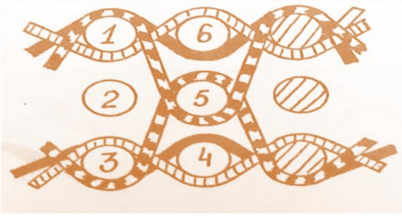
Şək.1.13. Üçüncü sinifin dördüncü qrupunun çoxqatlı parçasının sxemi
