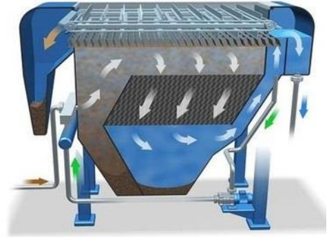
Şəkil 2.11. Su təmizləyici qurğulardakı təzyiqliq flotasiyası qurğusu
