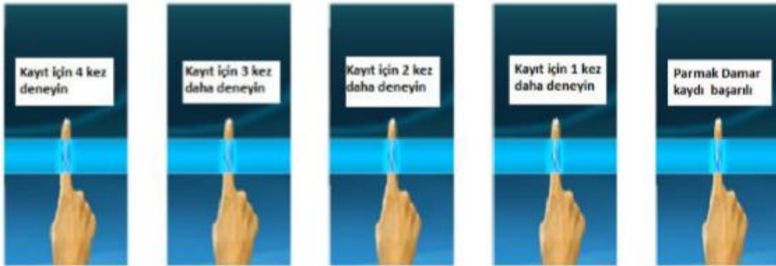
Şəkil 2.28. KfV-100 cihazının barmaq damar xəritəsinə görə parolun yaradılması prosesi
