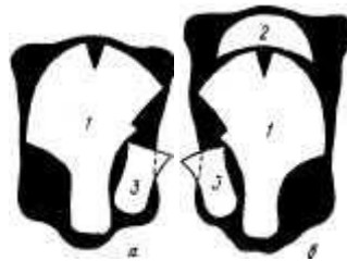
Şəkil 2.4. Uşaq baş geyimlərinin bir hissəsində "yarım maska" ilə daha kiçik (a) və daha böyük (b) sahənin kəsilməsi sxemi: 1 - yanaqlar; 2 - visor; 3 - saxta qulaqlıq
