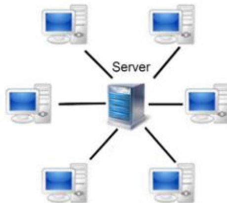
Şəkil 2.7 Ulduz topologiyasının quruluş sxemi
