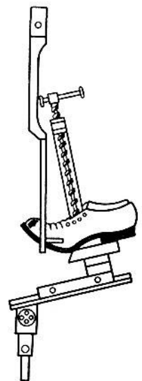
Şəkil 15. Ayaqqabı konstruksiyasının elastikliyini təyin edən cihaz
