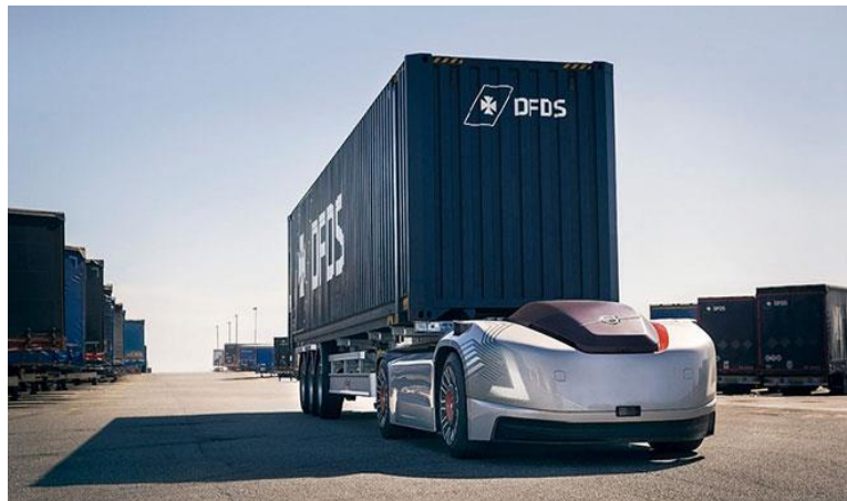
Şəkil 2. “ Volvo Vera ” sürücüsüz yük maşını
