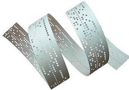
Hesablama maşınlarında informasiya daşıyıcısı kimi istifadə edilən perfolent
