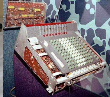
Dorr Feltin yaratdığı komptometrlər (ortada nəticəni çap edə biləcək qurğu, sağda ANITA Mark VII elektron kalkulyatoru)
