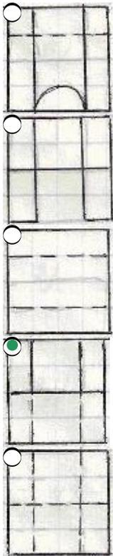
650 На каком чертеже согласно двум проекциям правильно построена горизонтальная проекция модели?
