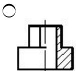
115 По заданным двум проекциям правильно определить третью проекцию.
