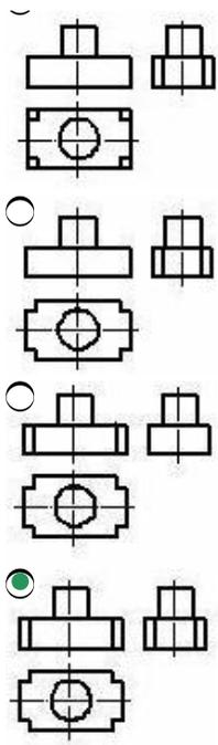
165 По наглядному изображению модели определить ее изображение на комплексном чертеже.
