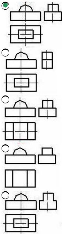
166 По наглядному изображению модели определить ее изображение на комплексном чертеже.
