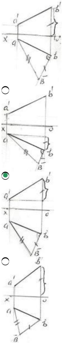
402 На каком чертеже изображен угол наклона заданной прямой к горизонтальной плоскости проекций?
