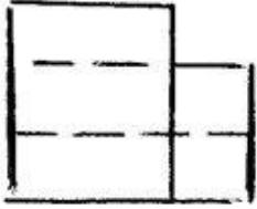
12 Согласно двум проекциям модели, определите, на каком чертеже правильно построена третья?
