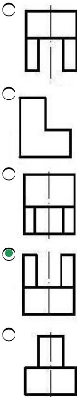
40 По заданным двум проекциям правильно определить третью проекцию.
