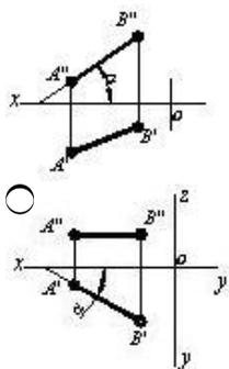
403 На каком чертеже изображен угол наклона заданной прямой к фронтальной плоскости проекций?
