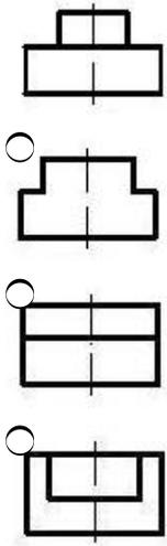
19 По заданным двум проекциям правильно определить третью проекцию.
