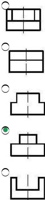
20 По заданным двум проекциям правильно определить третью проекцию.
