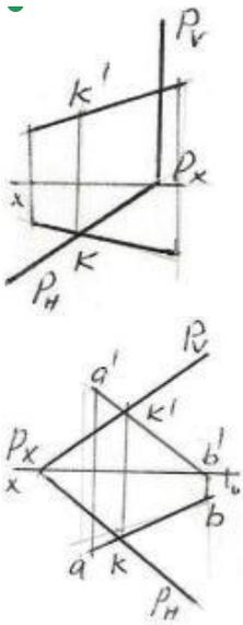
602 Hansı epyurda P və Q ilə müstəviləri arasındakı məsafənin əsl ölçüsü l düzgün göstərilmişdir?
