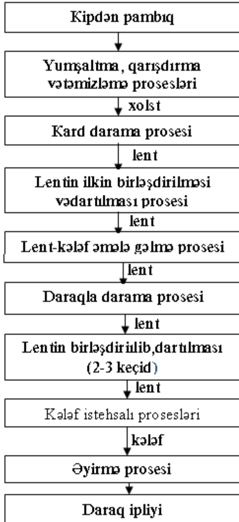
Şəkil 50. Daraq əyirmə sistemində iplik istehsalının sxemi
