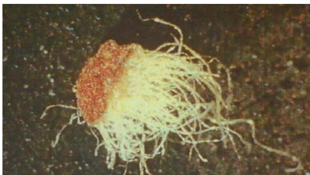
Şəkil 6. Çiyid qabığından ibarət olan qüsurlu pambıq lifi nümunəsi
