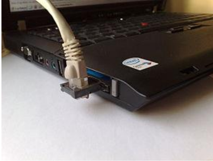
Şəkil 2.14. Noutbuka quraşdırılmış 3Com 3CXFE575CT şəbəkə kartı (platası)
