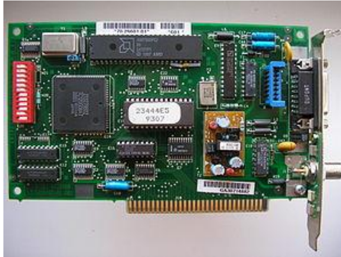
Şəkil 2.13. ISA şəbəkə platası (kartı). Yuxarıda AUI, aşağıda BNC ayırıcıları (razyomları) ilə
