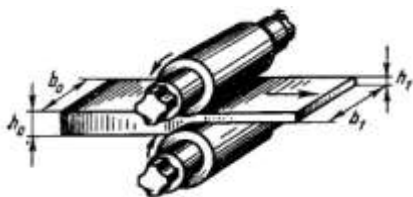
Şəkil 4.10. Metalın vallarla yayılma sxemi
