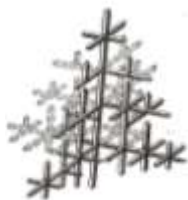
Şəkil 1.20. Dendrit kristalı (D.K.Çernova görə)
