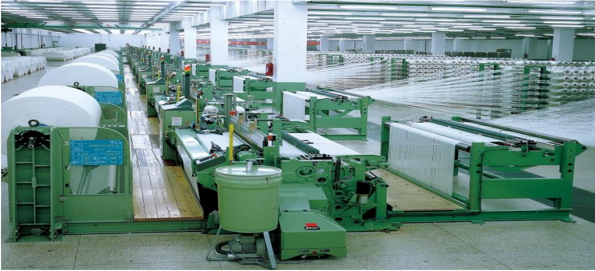
Şək.4.11.Toxucu sexində rapirəli toxucu maşınların birbaşa əriş çərçivəsindən yüklənməsi
